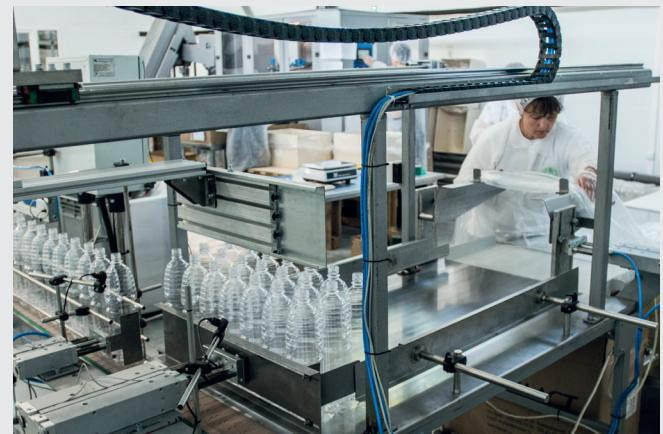
С конвейера бутылки поступают на фасовочную площадку — их принимают в большой такой мешок, фасовщик добавляет упаковку крышек, маркирует и отправляет на склад. Вот таков путь бутылки, все не так уж и сложно.
