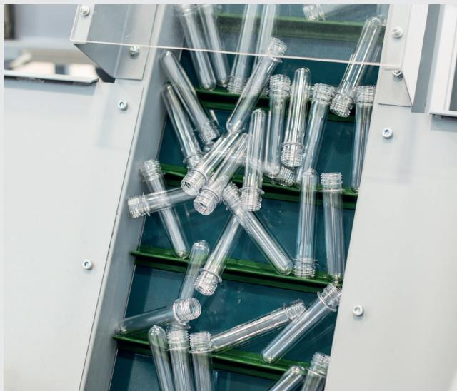
Правильно поставленные заготовки идут по конвейеру на формовку, по три штуки за раз. Линий на ЗУМ'е две, на 1000 и 3000 бутылок в час соответственно. Обе организованы по одному и тому же принципу, просто горла бутылок делаем двух разных «калибров».
